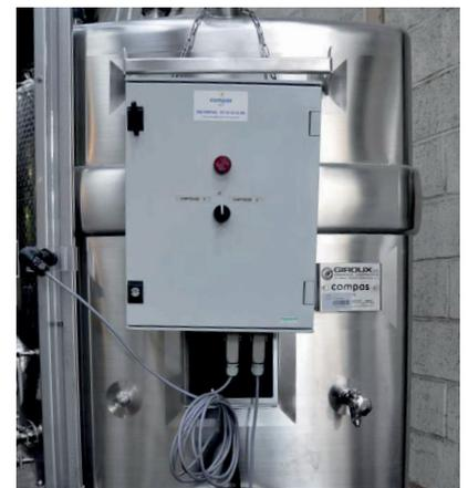
**CAPTEUR DE NIVEAU POUR CUVE
